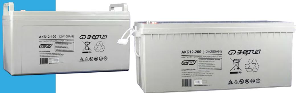
Аккумуляторы серии «Энергия АКБ» созданы по технологии AGM и рассчитаны на большую нагрузку в тяжелых условиях эксплуатации. Отличие батарей типа AGM от классических в том, что в них содержится абсорбированный электролит, а не жидкий. Аккумулятор, произведенный по технологии AGM, имеет перед классическими моделями ряд преимуществ: устойчивость к вибрации, отсутствие необходимости обслуживания, установка практически в любом положении.
