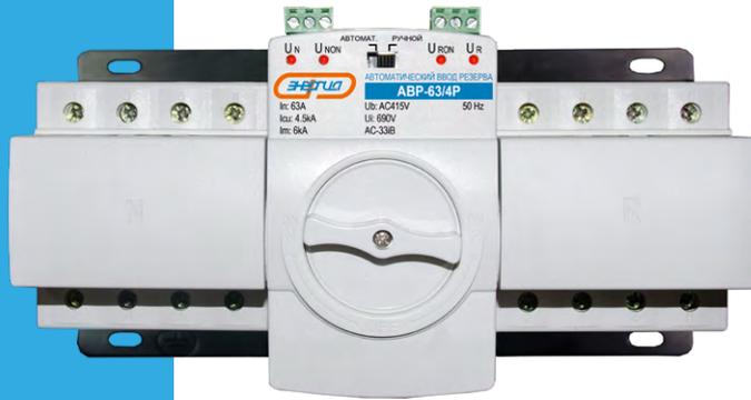
Устройство автоматического ввода резерва предназначено для автоматического перехода на резервный ввод в сетях переменного тока с частотой 50 Гц, номинальным рабочим напряжением 220 В (для моделей АВР 63/2Р), 380 В (для моделей АВР 63/4Р) и номинальным рабочим током до 63 А. Применяется на промышленных, коммерческих и бытовых объектах, а также в жилых домах.
