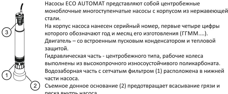
В верхней части насоса расположен электронный блок управления с датчиком минимального давления и датчиком потока (3).
