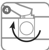
Поверните винт сброса давления в положение «Закрыть».
