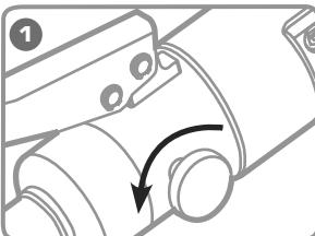
Поверните винт сброса давления в положение «Открыто».
