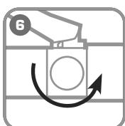
Поверните винт сброса давления в положение «Открыть».
