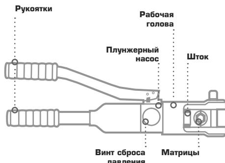
Для полного сброса давления на инструменте расположен дроссельный винт, работающий в положении «закрыто» / «открыто»
