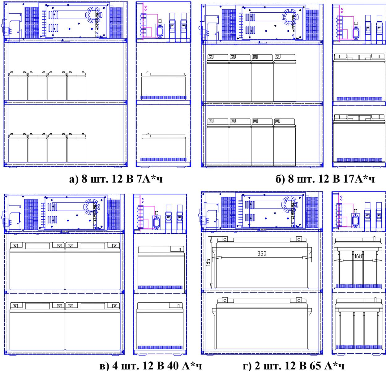
Рисунок 2.2 – Пример расположения АБ в ИБП Штиль
