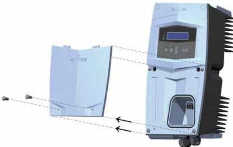
Рисунок 6.8: Демонтаж нижней крышки
