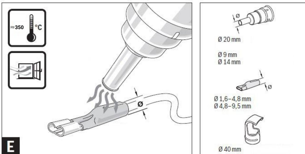
Насадите редукционное сопло. Выбирайте диаметр термоусаживаемого шланга соответственно детали (например, кабельный наконечник). Равномерно нагревайте термоусаживаемый шланг.
