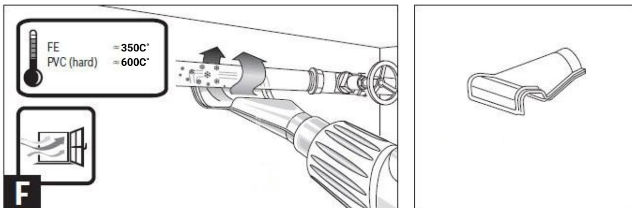
**⚠ ВНИМАНИЕ!** Перед нагреванием проверьте, действительно ли это водопровод! Водопроводы снаружи часто не отличаются от газопроводов. Газопроводы нельзя ни в коем случае нагревать.
