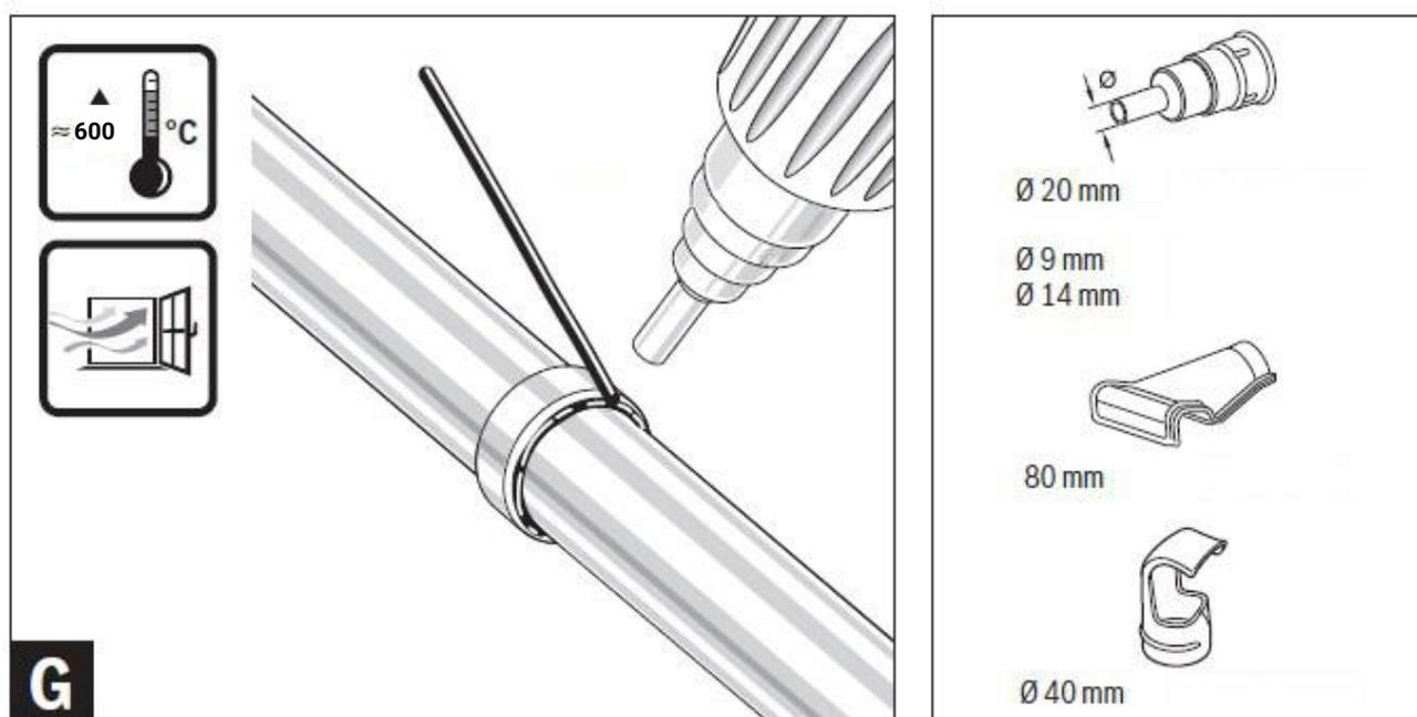
Для точечной пайки надевайте редукционное сопло, для пайки труб – рефлекторное сопло.
