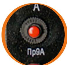
защита от перегрузок и короткого замыкания (автоматический предохранитель или выключатель)
