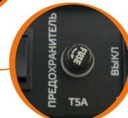
предохранитель входной цепи
