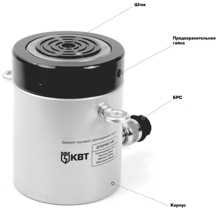
Домкраты гидравлические, грузовые с фиксированной гайкой состоят из корпуса с гидроцилиндром, штока с рифленой опорой, предохранительной гайки и быстроразъемного соединения БРС
