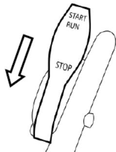
Плавно потяните рукоятку стартера до тех пор, пока вы не почувствуете сопротивление, затем резко дерните рукоятку.
