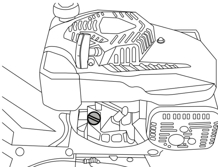
**ВНИМАНИЕ! Во избежание попадания масла в камеру сгорания во время работы держите двигатель горизонтально. Наклоны двигателя свыше 10 градусов должны быть кратковременными.**
