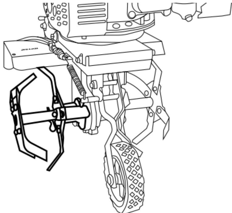
Установите сошник, используя для этого болт и гайку из комплекта (либо палец и шплинт). Сошник обеспечивает различную глубину обработки почвы. Правильная глубина культивации снизит рабочую нагрузку на механизмы. Выбор глубины культивации зависит от почвы, поэтому рекомендуется сделать вначале несколько пробных проходов, чтобы определить нужное положение сошника. После этого вы сможете оптимально обработать свой участок.
