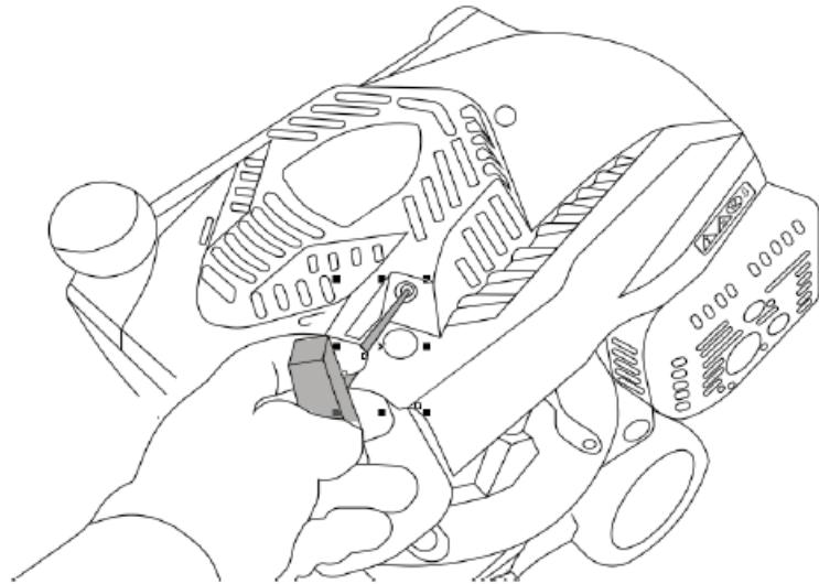
Отрегулируйте желаемые обороты двигателя с помощью рычага управления дроссельной заслонкой.
