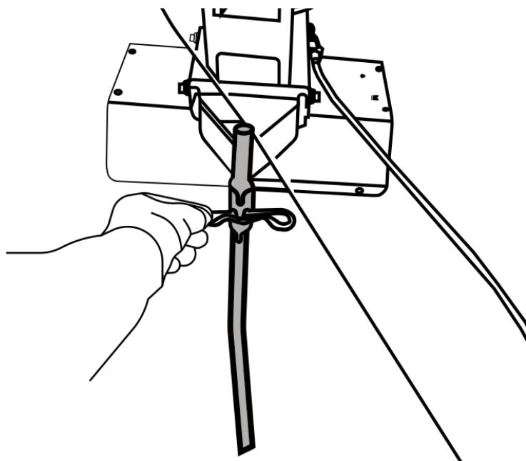
При необходимости перекатки мотокультиватора, установите опорное колесо на мотокультиватор.
