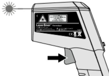
Gdy tylko koło laserowe uchwyci żądane miejsce pomiaru należy zwolnić przycisk. Zmierzona wartość zostanie zapamiętana.
