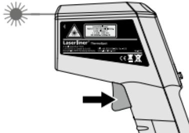
Suelte la tecla cuando haya detectado el lugar de medición deseado con el círculo láser. El valor medido se mantiene.
