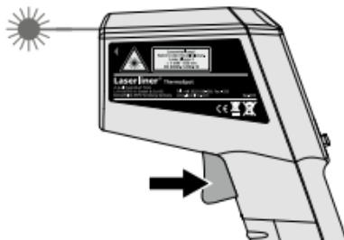
Solte a tecla logo que o local de medição pretendido seja detetado pelo círculo laser. O valor medido é mantido.
