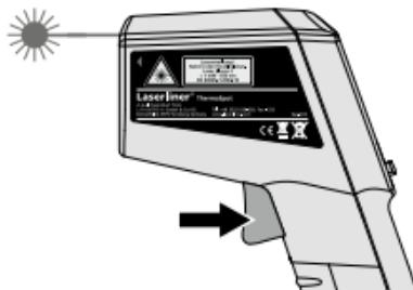
Så snart det ønskede målesteds detekteres med lasercirklen, slipper man knappen. Den målte værdi fastholdes.
