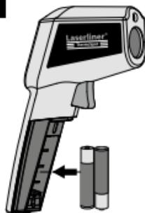
Tänk på att vända batteriernas poler åt rätt håll.
