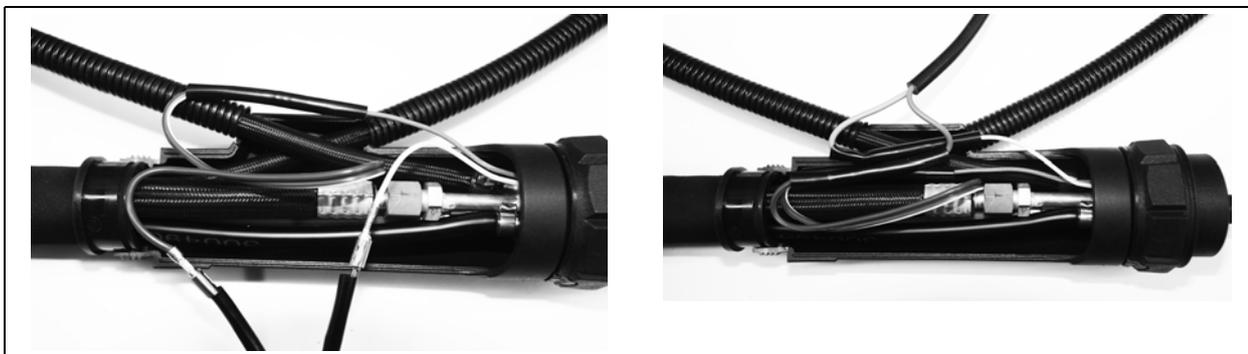
**Рис. 16** Соединение провода датчика с проводом реле расхода
