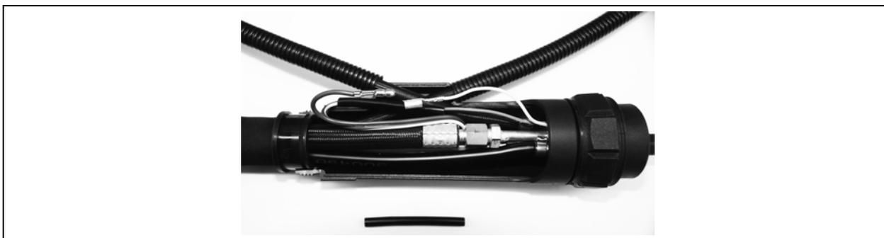
**Рис. 15** Демонтаж провода датчика
