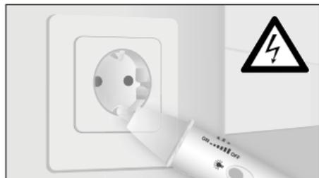
Si une tension est présente, la pointe du détecteur s'allume et un signal retentit.
