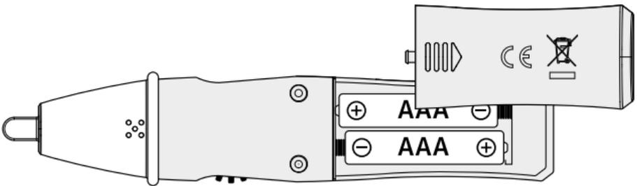
**!** Inden hver ibrugtagning skal man kontrollere apparatet under en kendt hjælpekrede svarende til apparatets angivne spændingsområde. For at undgå fejlmålinger skal man inden ibrugtagning teste batterierne ved at tænde den integrerede lommelygte. (se pkt. 5)
