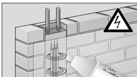
Se for detectada tensão, a ponta do detector acende e soa um sinal.
