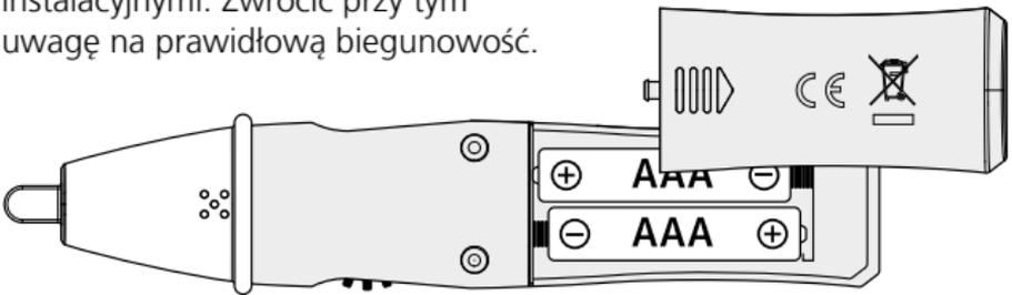
**!** Przed każdym użyciem należy sprawdzić urządzenie na znanym obwodzie prądu roboczego zgodnie z podanym zakresem napięcia urządzenia. W celu unikania błędnych pomiarów należy przed użyciem sprawdzić baterie poprzez włączenie zintegrowanej latarki. (patrz punkt 5)
