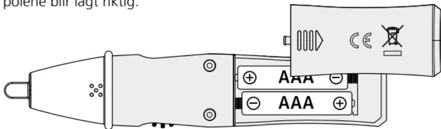
**!** Test apparatet før bruk på en kjent strømkrets i henhold til apparatets spenningsområde. For å unngå feilmålinger skal du kontrollere batteriene før bruk ved å slå på den integrerte lommelykten. (Se punkt 5.)
