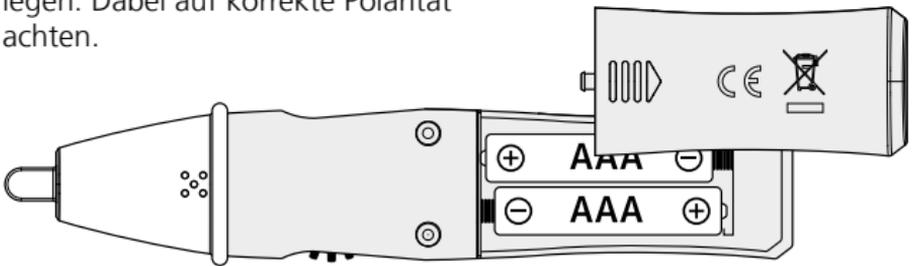
**!** Prüfen Sie das Gerät vor jeder Benutzung unter einem bekannten Betriebsstromkreis laut angegebenem Spannungsbereich des Gerätes. Um Fehlmessungen zu vermeiden, prüfen Sie die Batterien vor Gebrauch durch Einschalten der integrierten Taschenlampe. (siehe Punkt 5)
