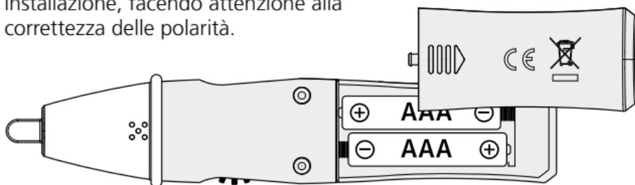
**!** Prima di ogni utilizzo controllare l'apparecchio sotto un circuito elettrico in esercizio conosciuto in base al campo di tensione indicato dell'apparecchio. Per evitare errori di misura, verificare le batterie prima dell'uso accendendo la minitorcia integrata (vedi punto 5).
