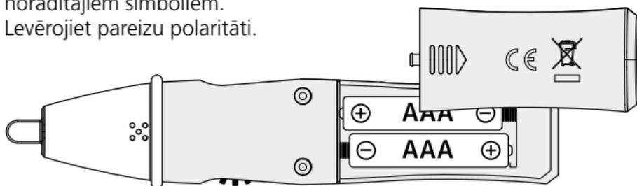
**!** Pārbaudīt detektoru pirms katras ekspluatācijas reizes. Pārbaudi veic elektriskajā ķēdē, kur ir zināms darba spriegums, un vadās pēc detektora norādītā sprieguma diapazona. Lai panāktu detektora nekļūdīgu darbību, pirms tā ekspluatācijas pārbauda baterijas, ieslēdzot integrēto lampaņa. (skatīt 5. punktu)
