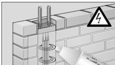
Hvis der findes spænding, lyser detektorspidsen, og der lyder et signal.
