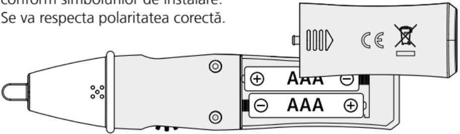
**!** Înaintea fiecărei utilizări, verificați aparatul într-un circuit electric funcțional cunoscut conform intervalului de tensiune indicat al aparatului. Pentru a evita măsurătorile eronate, verificați bateriile înainte de utilizare prin pornirea lanternei integrate. (vezi punctul 5)
