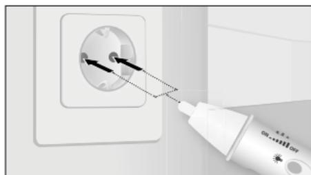
Așezați vârful detector pe zona de verificat (de ex. cablu, priză, etc.).
