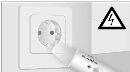
При наличии напряжения щуп загорается, и звучит акустический сигнал.
