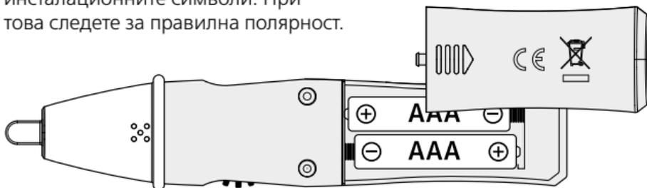
**!** Преди всяко използване проверявайте устройството в познат работен токов контур съгласно посочения диапазон на напрежение на устройството. За да избегнете неправилни измервания, преди употреба проверявайте батериите чрез включване на интегрираното джобно фенерче. (вижте т. 5)
