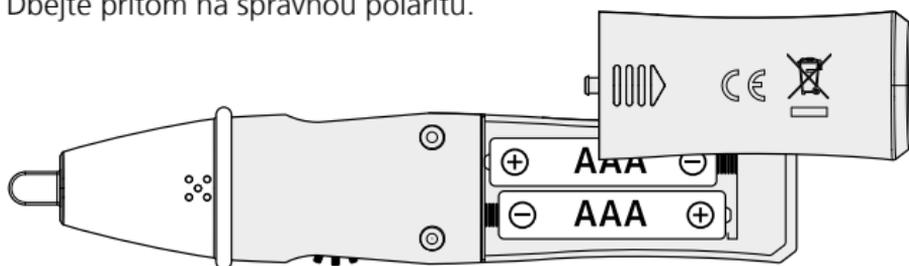
**!** Před každým použitím přístroj zkontrolujte při známém obodu provozního proudu podle uvedeného napěťového rozsahu přístroje. Aby nedošlo k chybnému měření, zkontrolujte před použitím baterie zapnutím integrované kapesní svítilny. (viz bod 5)
