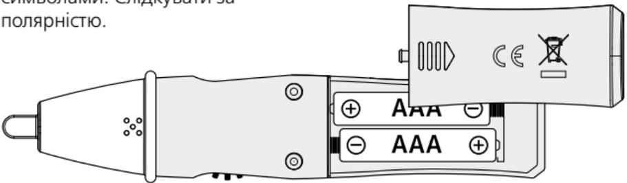
**!** Перед кожним використанням перевіряйте прилад на знайомому колі робочого струму відповідно до зазначеного діапазону напруг. Щоб уникнути невірних вимірів, перед використанням перевіряйте батарейки шляхом умикання вбудованого кишенькового ліхтарика. (див. п. 5)
