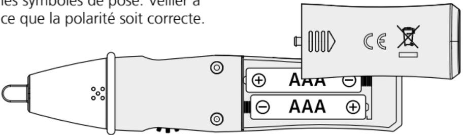
**!** Avant toute utilisation, vérifier le bon fonctionnement de l'appareil dans un circuit de service connu en fonction de la gamme de tension indiquée pour l'appareil. Pour éviter des erreurs de mesure, contrôler les piles avant toute utilisation en allumant la lampe de poche intégrée (voir le point 5)
