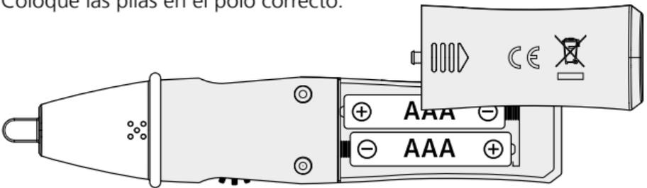
**!** Compruebe el funcionamiento del aparato, antes de cada uso, en un circuito de servicio conocido y conforme con el rango de tensión especificado del aparato. Para evitar errores en las mediciones compruebe el estado de las pilas antes del uso encendiendo la linterna integrada (ver punto 5).
