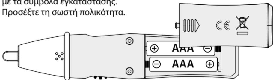
**!** Ελέγχετε τη συσκευή πριν από κάθε χρήση σε ένα γνωστό ηλεκτρικό κύκλωμα λειτουργίας σύμφωνα με την αναφερόμενη περιοχή τάσης της συσκευής. Για να αποφευχθούν λανθασμένες μετρήσεις, ελέγχετε τις μπαταρίες πριν τη χρήση ενεργοποιώντας τον ενσωματωμένο φακό. (βλέπε σημείο 5)
