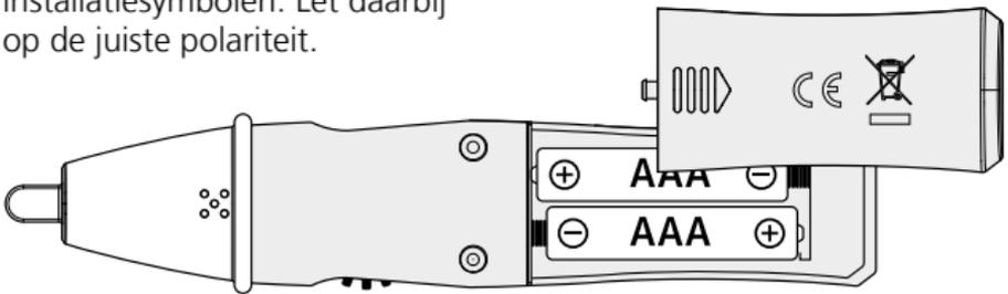
**!** Controleer het apparaat vóór ieder gebruik op een bekend bedrijfsstroomcircuit volgens het aangegeven spanningsbereik van het apparaat. Voorkom verkeerde metingen en controleer de batterijen vóór gebruik van het apparaat, door de geïntegreerde zaklamp in te schakelen (zie punt 5).
