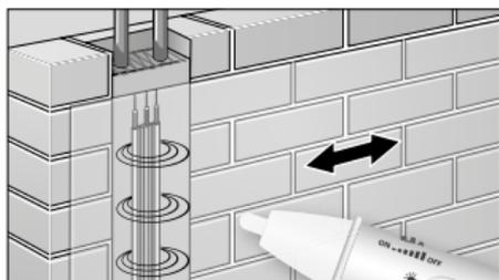
La sensibilidad del aparato (5 ... 1000 VAC) puede ajustarse girando la rueda (2). De este modo se puede localizar campos de tensión a distancias mayores moviendo el aparato sobre la zona a comprobar.
