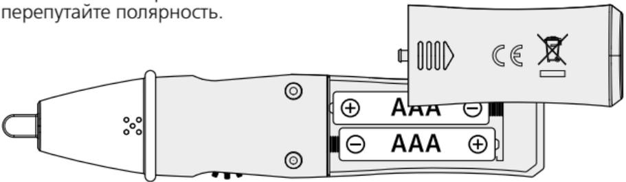
**!** Перед каждым использованием прибор следует проверять в цепи с известным рабочим током и с соблюдением указанного диапазона напряжений прибора. Во избежание неправильных измерений перед использованием прибора необходимо проверять батареи включением встроенного карманного фонаря. (см. пункт 5)
