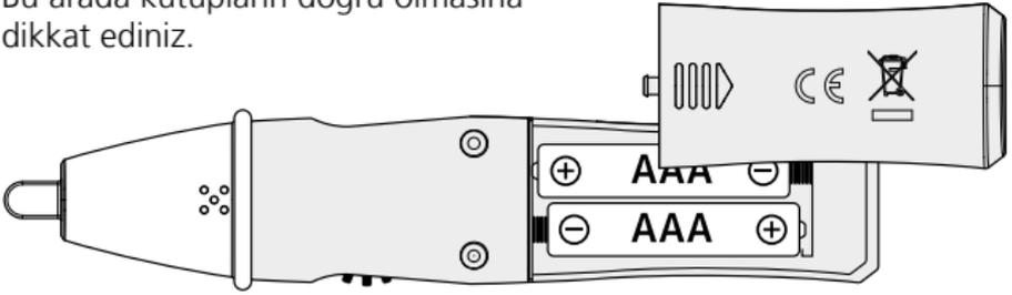
**!** Cihazın işlevini, her kullanımdan önce cihazın çalışma aralığında bulunan elektrik taşıdığı bildiğiniz bir devre üzerinde kontrol ediniz. Hatalı ölçümleri önlemek için, kullanımdan önce el fenerini çalıştırarak pilleri kontrol ediniz. (md. 5'e bkz.)
