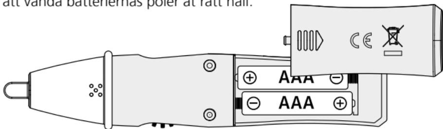
**!** Testa apparaten före varje användning med en bekant driftströmkrets i enlighet med angivet spänningsområde för apparaten. För att undvika felmätningar, testa batterierna före användning genom att slå på den inbyggda ficklampan. (Se punkt 5.)
