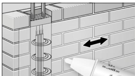
Otáčením kolečka (2) lze nastavit citlivost přístroje (5 ... 1000 VAC). Napěťová pole na lze na větší vzdálenost lokalizovat tak, že se přístrojem pohybuje nad měřenou oblastí.
