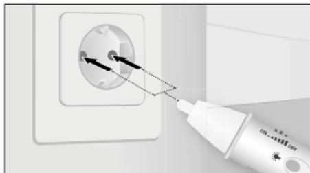
Setzen Sie die Detektorspitze auf den zu prüfenden Bereich (z.B. Kabel, Steckdose, etc.).
