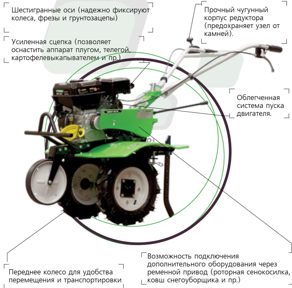
В комплект поставки аппарата входят 24 усиленные почвофрезы предназначенные для тяжелых грунтов. Фрезы собраны в 4 группы (3+1) с возможностью съема одной секции для уменьшения ширины обработки.
