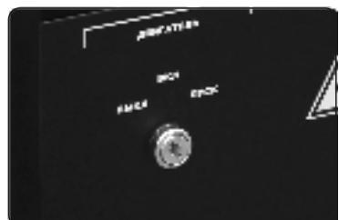
(c) Установите выключатель в положение «ВЫКЛ».
